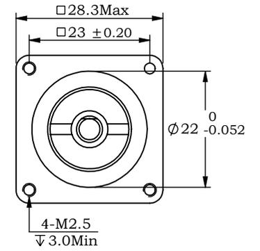
※ 电机规格/Motor Specification
